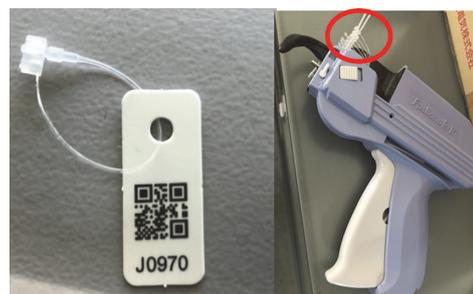
図 3. 個体識別に用いた QR コードラベルおよびループ (左) と装着に用いたタグガン (赤丸部にループを装填) (右)
